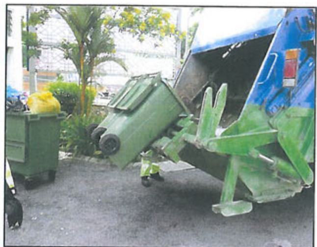
Gambar 2-9 : Kerja pemungutan oleh lori kompaktor dengan menggunakan bin lifter
